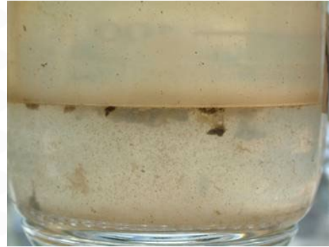
Émulsification à l'interface carburant-eau : des gouttelettes d'eau microscopiques se retrouvent en suspension dans le carburant
