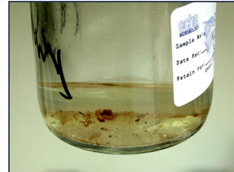
Substance polymérique extracellulaire bactérienne (EPS) translucide avec d'autres particules entraînées.
