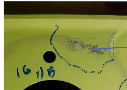
Corrosion de bac de carburant d'un avion
