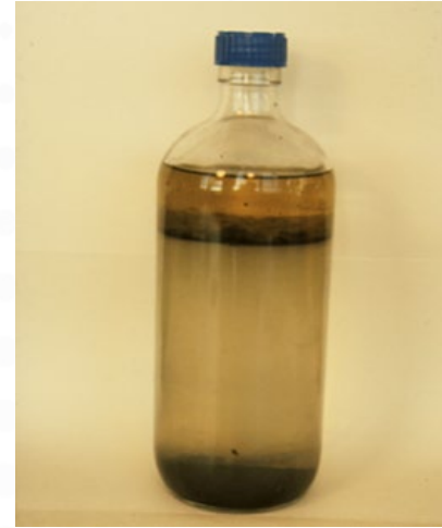
Coloration noire/grise de l'eau et du carburant au fond des bacs due à la production de sulfure par les bactéries sulfato-réductrices (SRB)
