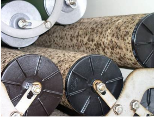
Taches de léopard / prolifération fongique sur les éléments séparateurs du Filtre Séparateur (EI 1581)
