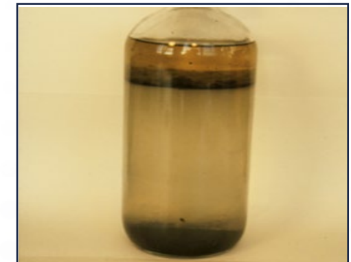
Couleur noire/grise de l'eau et du carburant due à la production de sulfure par les bactéries sulfato-réductrices (SRB)
