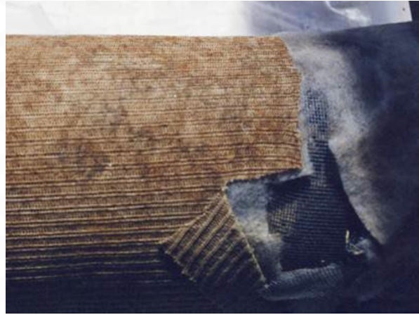
Taches de léopard / prolifération fongique sur les éléments séparateurs du Filtre Séparateur (EI 1581)
